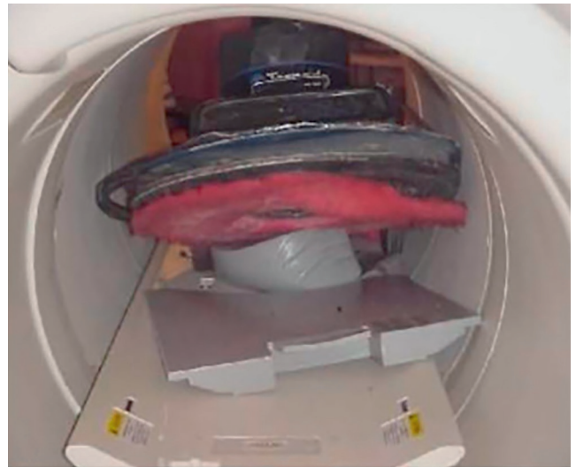
Figure 2.2. Effet missile avec une polisseuse industrielle. Quench manuel obligatoire.
